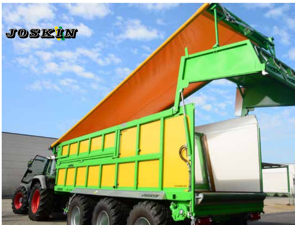
Eine Öffnung der Heckklappe ist möglich auch wenn die Plane geschlossen ist.
