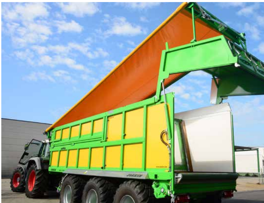
Otwieranie klapy jest możliwe, nawet gdy plandeka jest założona
