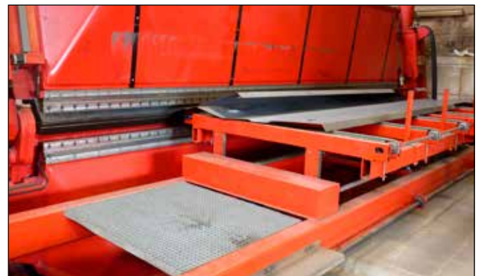
Пресс с ЧПУ с силой давления 600 тонн
